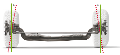
(King Pin Inclination) inclinazione perno di sterzaggio
