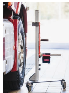
Outil de détection sans contact du châssis et de la carrosserie
