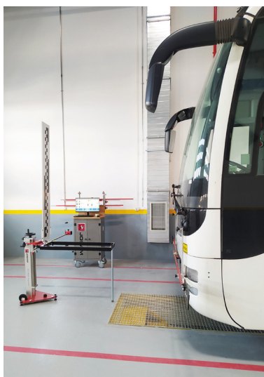
Calibración de la cámara en el bus
