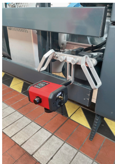
Calibración del radar lateral
