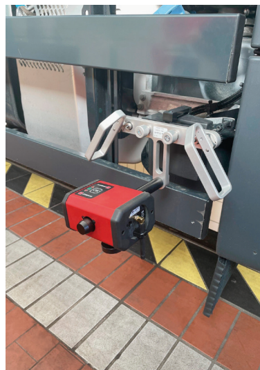
Calibración del radar lateral (Se necesita un adaptador de radar MAN)
