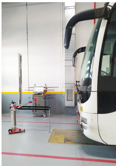
Calibración de la cámara en el bus
