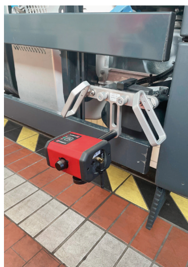
Calibrazione del radar laterale (necessario adattatore radar MAN)
