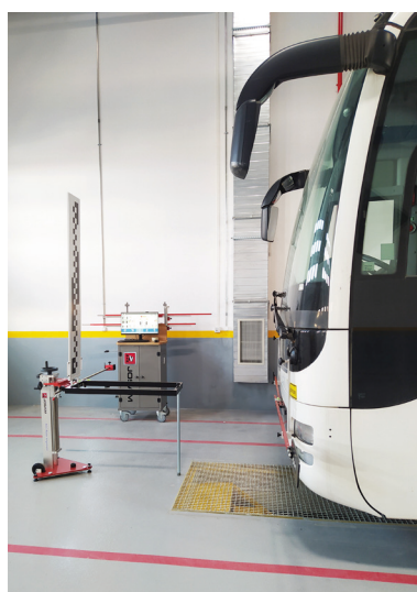
Calibrazione della telecamera su un autobus
