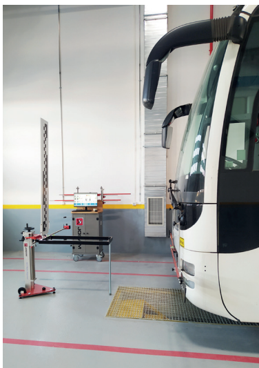
Kamerakalibrierung am Bus
