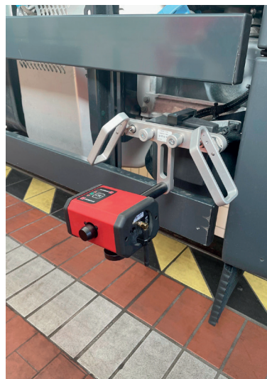
Kalibrierung des Seitenradars (MAN-Radaradapter erforderlich)
