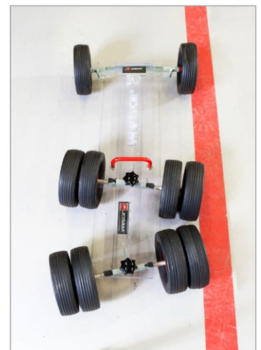
Snedställda och oparallella axlar Out of square and non-parallel axles Schräg und unparallele Achsen
