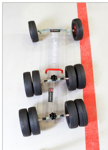
Snedställda och parallella axlar Out of square and parallel axles Schräg und parallele Achsen
