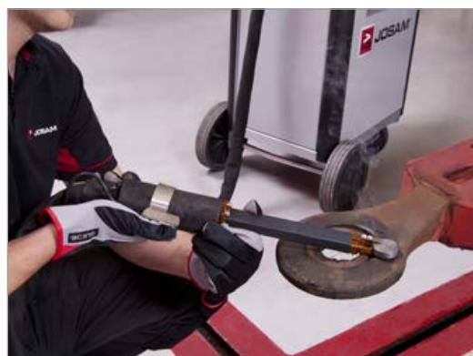
**JH 1500-400 K, JH1500-200 K/15079, 15358****Induction heater JH1500****Induktionsvärmare JH1500****Induktionserhitzer JH1500**
