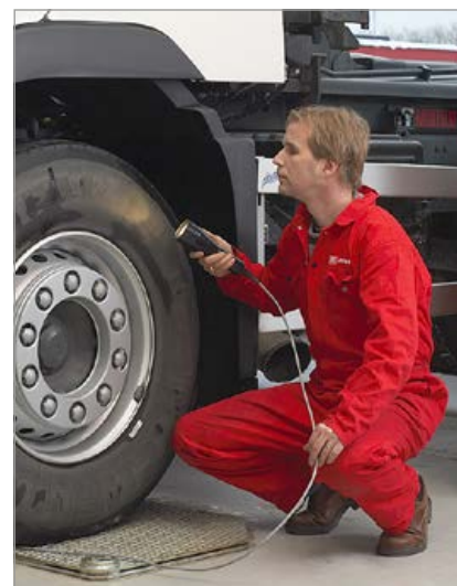
Speldetektorn installeras direkt på verkstadsgolvet Der Spieldetektor installiert direkt auf dem Boden The play detector can be installed directly on the floor
