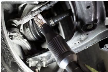
ALINEACIÓN DE RUEDAS APLICACIÓN Afloje las tuercas de la barra de acoplamiento con seguridad
