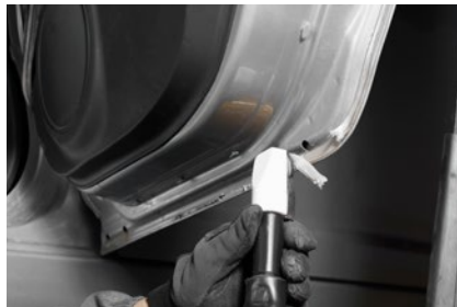
SOLICITUD DE REPARACIÓN DE COLISIONES Afloje suavemente la junta de la puerta
