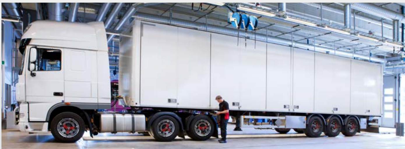
Zameriavanie kompletnej zostavy vozidla s návěsom
