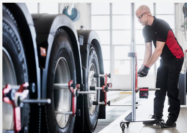
Herramienta de teledetección de chasis y carrocería
