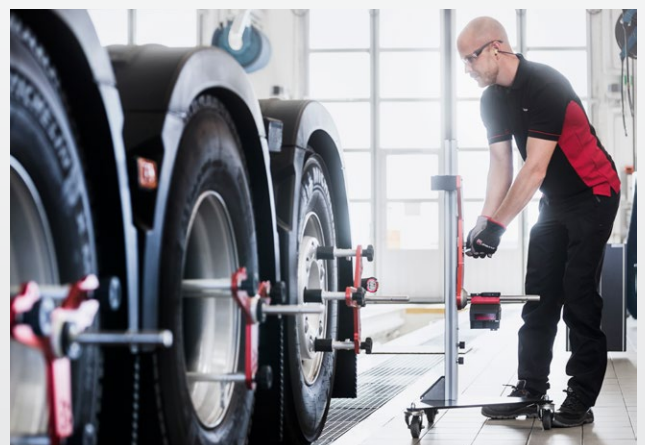
Berührungsloses Rahmen- und Aufbaumessgerät
