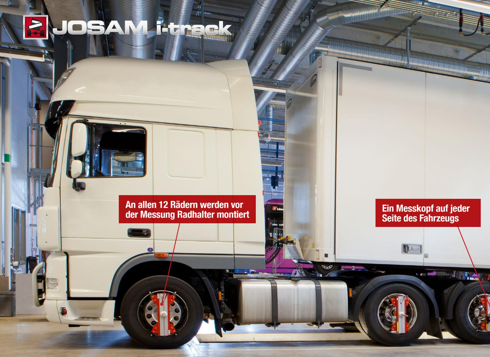
An allen 12 Rädern werden vor der Messung Radhalter montiert
