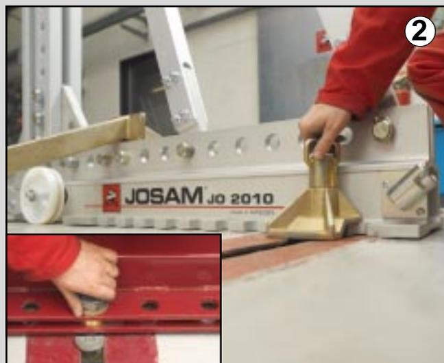
As vigas "I" embutidas seguem o mesmo princípio do sistema de alinhamento de chassis Josam. Com um simples giro nas travas, as torres são fixadas dentro das vigas "I" no piso da oficina. A base para alinhamento Josam também pode ser usada nas vigas "I".
