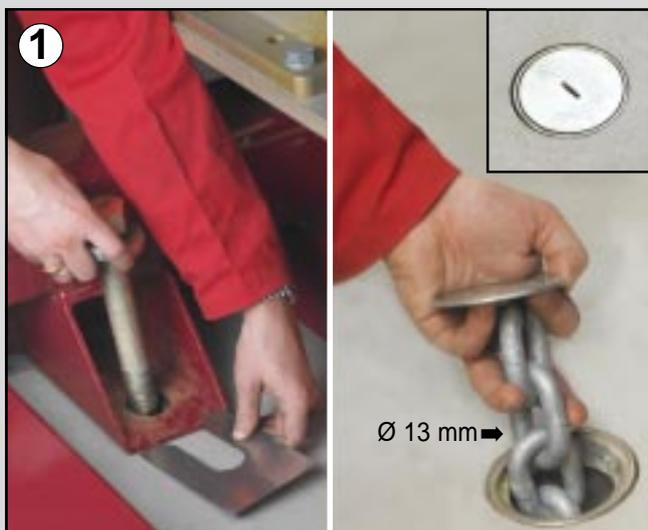
A ancoragem no piso é fácil de ser realizada e permite a fixação das torres para cabines, correntes ou da base para alinhamento Josam que pode ser travada com 4 parafusos (foto acima à esquerda). Quando as buchas de expansão não são usadas, podem ser cobertas com a tampa de proteção.
