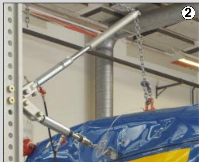
Independente da alternativa escolhida, a torre para cabines JOSAM pode ser usada para vários tipos de reparação graças à sua versatilidade. Nesse caso, por exemplo, é possível realizar o estiramento de uma cabine a 3 ou 4 metros de altura com o uso de um cilindro hidráulico e seus alongadores.
