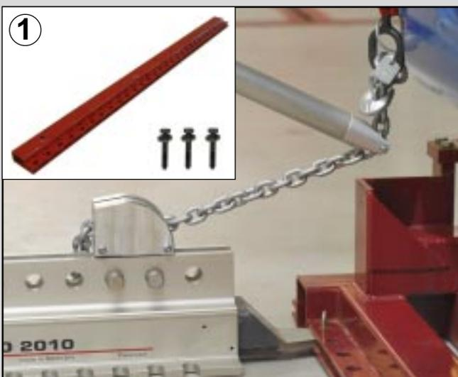
O kit de parafusos para travamento permite que a torre seja acoplada diretamente à base para alinhamento. Para os trabalhos em carrocerias longas, a torre pode ser usada em conjunto com uma viga móvel de ancoragem com 3 parafusos - travas para fixação.
