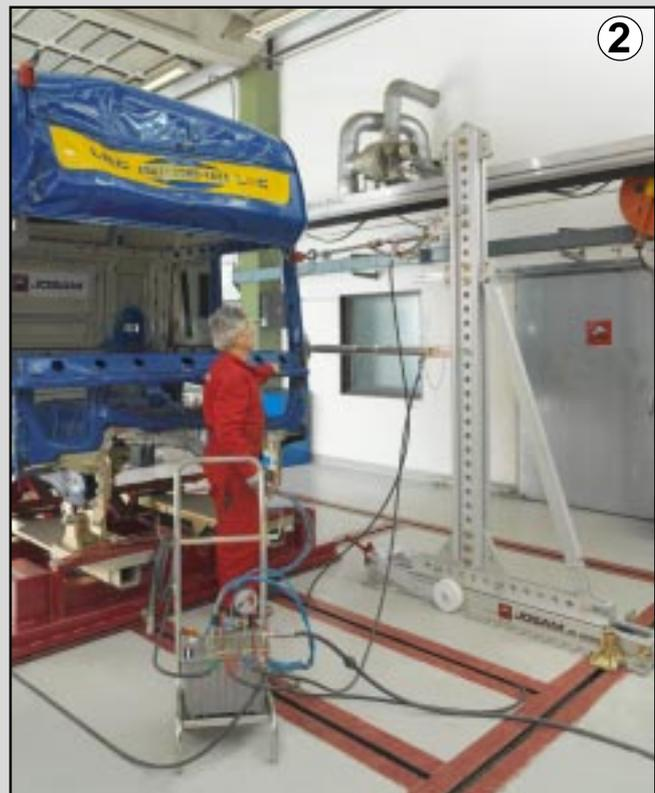
O sistema convencional de ancoragem com vigas "I" permite o travamento da torre nas vigas que são instaladas em um quadrado ao redor da base para alinhamento.
