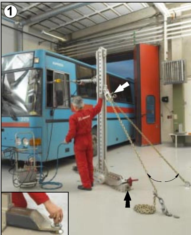
O sistema de ancoragem no piso é excepcional quando aplicado para reparos rápidos como na carroceria da foto. Nesse caso a torre é travada por um parafuso frontal e por correntes na traseira. A torre é pré-tensionada com uma chave de impacto (conforme foto abaixo). Os ângulos para estiramento podem ser facilmente ajustados para os lados e trava-se a corrente na torre por um pino (foto acima).
