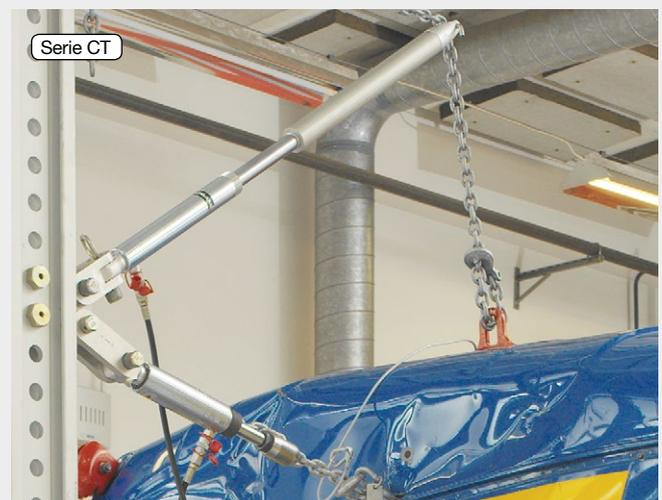
Non ci sono limiti per il modo di impiego, la torre di tiro JOSAM può essere utilizzata per diversi lavori di riparazione grazie alla sua versatilità. Qui, per esempio, una raddrizzatura con sistema di tiraggio avanzato viene effettuata a 3-4 metri di altezza.
