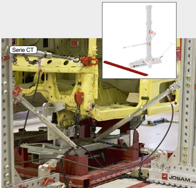
Il kit di ancoraggio permette al carrello di essere fissato direttamente al banco cabine per i lavori di raddrizzatura. Per le riparazioni laterali di autobus la torre di tiro viene fissata con un telaio mobile con tre bulloni di fissaggio.
