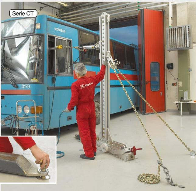
L'ancoraggio a pavimento è eccezionale quando bisogna riparare danni minori, come per questo autobus. In questo caso la torre di tiro è fissata con un ancoraggio direttamente nel foro di espansione sul davanti e con le catene sul dietro. La torre è pretensionata con una chiave pneumatica. L'angolo di tiraggio viene rapidamente modificato lateralmente e la torre bloccata con un perno.
