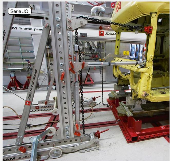
Il Sistema I-beam fissa la torre di tiro cabine nel telaio che è stato precedentemente installato, seguendo la forma della cabina stessa. Per entrambe i sistemi della serie CT e JO ci sono numerosi accessori, morsetti ed attrezzi per funzioni di tiraggio e spinta.
