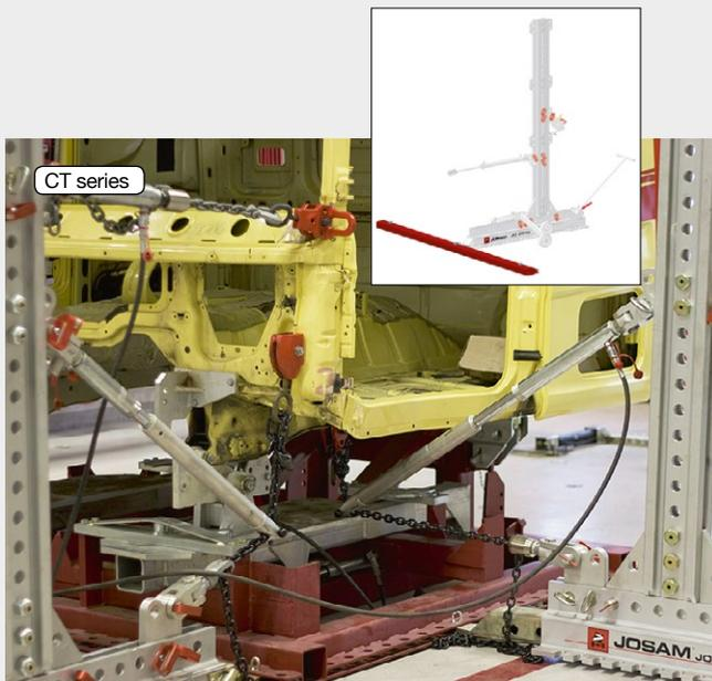
Le jeu de support avant permet de verrouiller le chariot directement sur le banc cabine pour les travaux de réparation de cabine.
