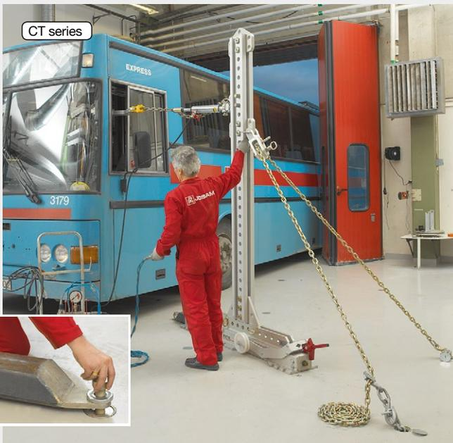
L'ancrage au sol est ingénieux lorsqu'il s'agit de petites réparations, comme pour cet autocar. Dans ce cas, la tour de cabine est fixée par un support avant directement sur l'orifice d'expansion à l'avant et par des chaînes à l'arrière. La tour est pré-tendue par une clef à chocs. L'angle de traction latérale est réglable facilement et la tour est verrouillée par les goujons.
