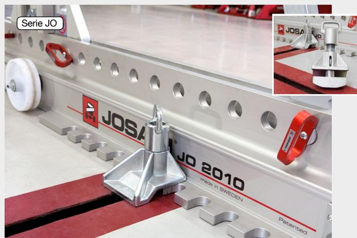
Los puntos de anclaje (orificios de expansión) del suelo del taller para la fijación de la torre son fáciles de instalar. La torre se fija con un tornillo en la parte delantera y expansores de cadena en la trasera.
