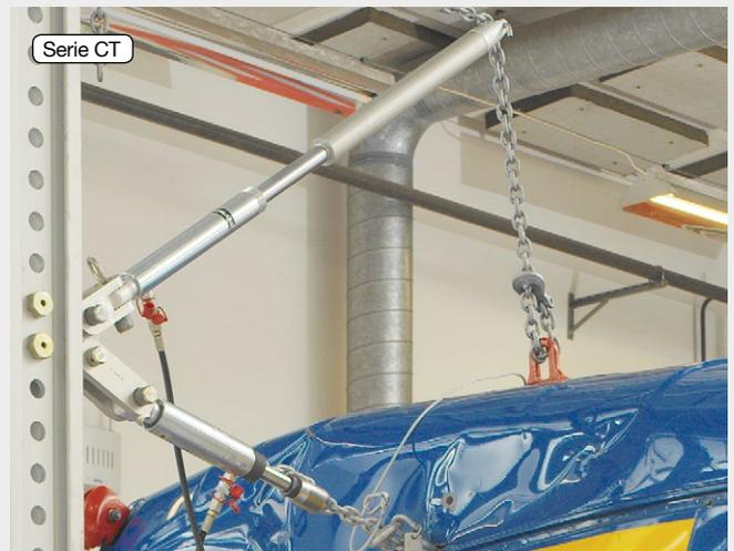
No importa que alternativa elija, la torre para cabinas JOSAM puede utilizarse para múltiples trabajos de reparación, gracias a su versatilidad. En la foto, por ejemplo, se muestra tiros vectoriales de forma avanzadas a la altura de 3-4 metros.
