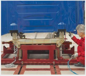
A parte traseira da bancada também é móvel, permitindo estiramentos verticais para correção de cabines torcidas. A cabine é pressionada para cima até a posição correta que é determinada pela estrutura da própria bancada de correção.
