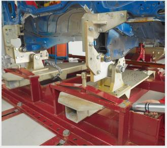
Os quatro pontos de fixação da cabine danificada são ancorados à base através de kit de adaptadores especialmente projetados para cada modelo de cabine. O deslocamento da parte frontal até o ponto correto é realizado com os cilindros hidráulicos apoiados na parte móvel da bancada. Pinos de trava são utilizados para guiar os pontos até a posição correta.
