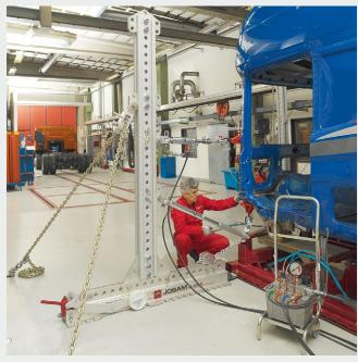
As colunas das cabines são estiradas com cilindros de compressão e tração fixados na torre. Essa foto mostra um vetor de compressão, que empurra para baixo a parte inferior da cabine simultaneamente ao estiramento, para fora, de um ponto (A) da coluna.
