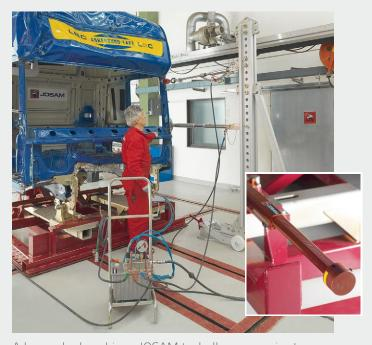
A bancada de cabines JOSAM trabalha em conjunto com as torres de alumínio e acessórios que são usados para empurrar e puxar. Nosso sistema laser de medição para cabines, JOSAM cabaligner, é acoplado diretamente na bancada e é usado para medições precisas de conferência.
