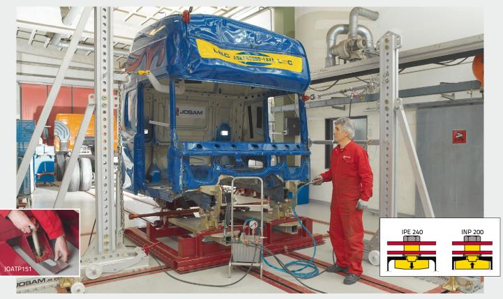
JOSAM cab bench é uma robusta e eficaz ferramenta para o endireitamento e alinhamento de cabines. A possibilidade de mudança dos pontos de montagem do equipamento facilita os trabalhos de reparação de pequenos e grandes danos. A base da cabine é puxada ou empurrada hidráulicamente até sua correta posição.
