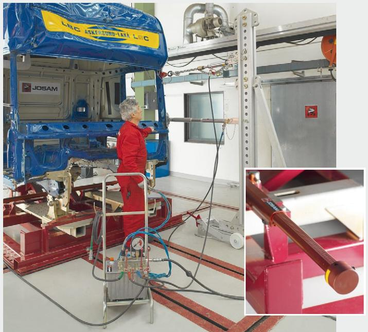
La tour de redressement en aluminium JOSAM s'adapte sur le banc ainsi que des outils de redressement en option. Notre système de mesure laser « JOSAM cabaligner » se positionne directement sur la cabine et est utilisé pour la mesure de contrôle.
