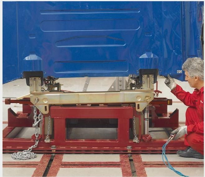
Même les fixations arrière sont amovibles ce qui permet de redresser une cabine vrillée. La cabine est redressée de manière à ce que la poutre de fixation soit de niveau avec le banc.
