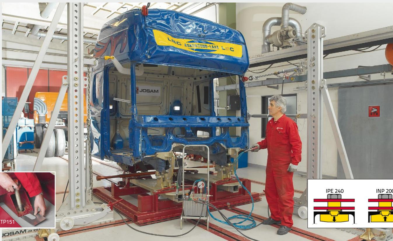
Un banc de redressage stable et robuste qui facilite le travail. Les ferrures amovibles facilitent l'ancrage des cabines endommagées. La base de la cabine est redressée à ses dimensions d'origine à l'aide d'hydraulique.
