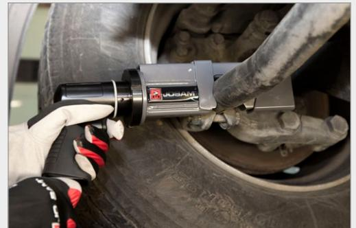
**Cuando la lubricación y el pulverizador antióxido no son suficientes para aflojar la barra de acoplamiento, esta herramienta de mano neumática es la solución.**
