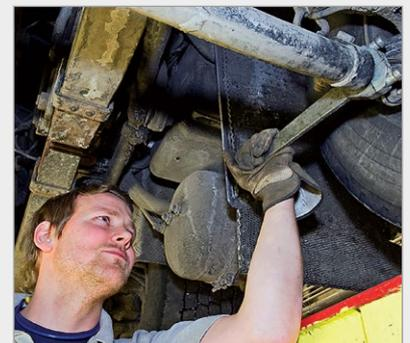
**Herramienta para aflojar la barra de acoplamiento (ajuste de convergencia) y barra de dirección.**
