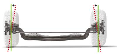
(King Pin Inclination) inclinazione perno di sterzaggio
